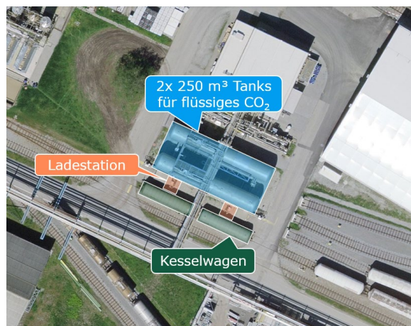
Abbildung 5-7 Beispiel CO 2 Verladung Kesselwagen.
